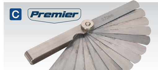
C VS511 15 Blade Feeler Gauge - Metric Blade dimensions 75 x 13mm. Blade Sizes: 0.06, 0.07, 0.08, 0.10, 0.15, 0.20, 0.25, 0.30, 0.35, 0.40, 0.45, 0.50, 0.55, 0.60, 0.70mm
